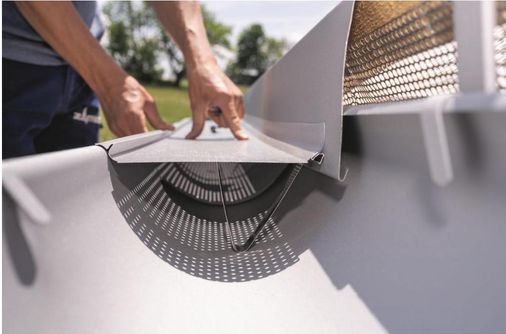
*Der Rinnenschutz Gutter Stark® besteht aus einem Aluminium-Laubschutzgitter mit integriertem Flex-Seal™ Überlaufstopband, einer Wulstklammer und einem Stützbügel. Foto: Zambelli Holding GmbH*
