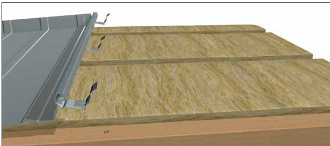
Poloha posuvných klipů (standardních klipů/směrových klipů) je určena šířkou profilovaného pásu.
