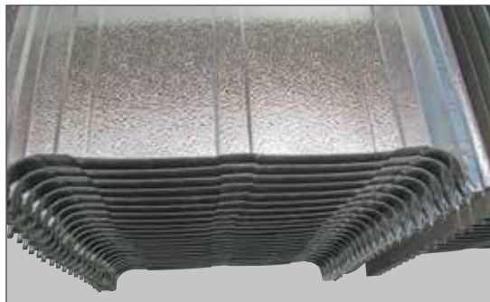
Skládání profilovaných pásů v našem výrobním zařízení, směr instalace zleva doprava
