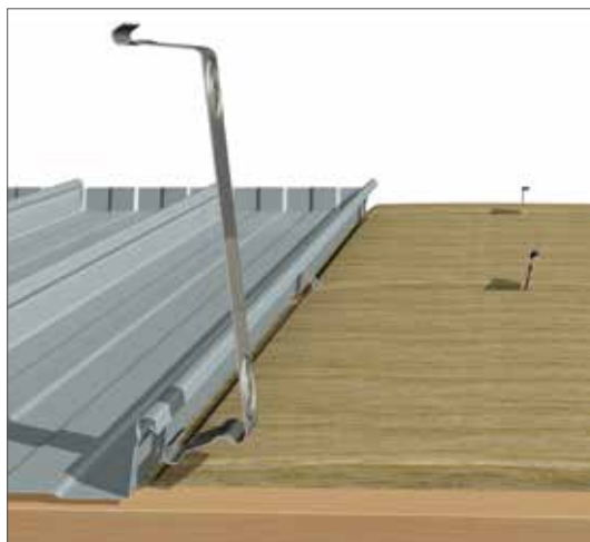
Konstrukční šířky by měly být během pokládky kontrolovány. Od 2. klipové řady je používán standardní klip.
