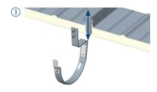
DE Obergurthalter mit eingeklebter EPDM-Dichtung formschlüssig an jedem zweiten Trapezsteg platzieren.
